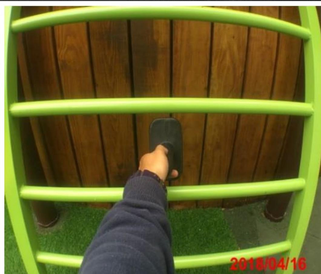
攀爬架橫桿間的空隙，均構成不當頭部誘陷的缺失。
