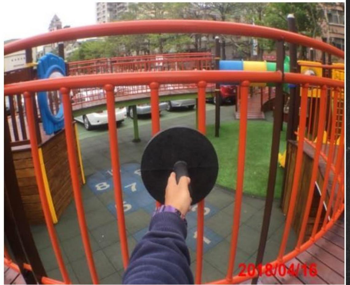
護欄間的空隙，均構成不當頭部誘陷的缺失。
