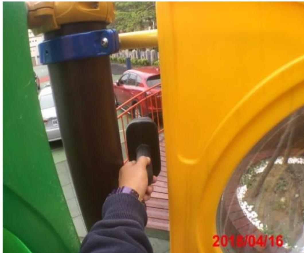
泡泡窗護欄與支柱間的空隙，左側位置構成不當頭部誘陷的缺失。
