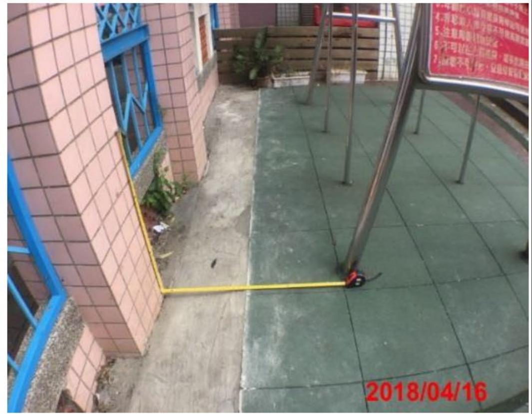
滑梯周邊至少183cm的使用區域內，出現場地高低落差的現象，且其使用區域內出現硬質的混凝土（水泥）地面及建築物牆面的障礙物，亦不符合要求。
