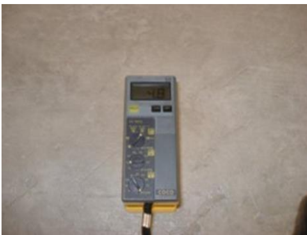
圖10.3：水分儀測定含水量
